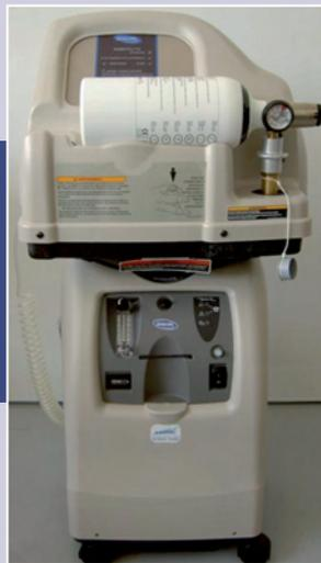
**Fig. 7** – Dispositif médical permettant le monitoring de l'observance de l'OLD (débit d'O<sub>2</sub> et temps de déambulation)
